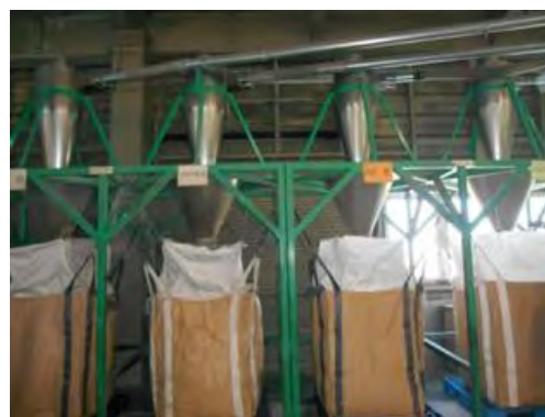
写真は、近赤外線を利用した樹脂材質に選別ライン。 4種類の材質に選別され、フレコンバッグに収納される。
