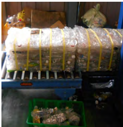
写真左・右 べール化されたペットボトルと選別された異物類
