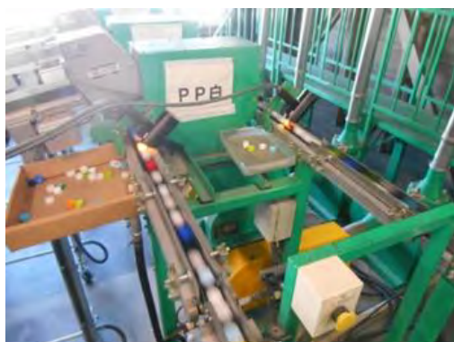
写真は、近赤外線を利用した樹脂材質に選別ライン。 4種類の材質に選別され、フレコンバッグに収納される。
