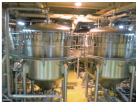
発酵・貯蔵タンク
